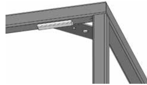
Glijders beschermen het frame bij het stapelen
